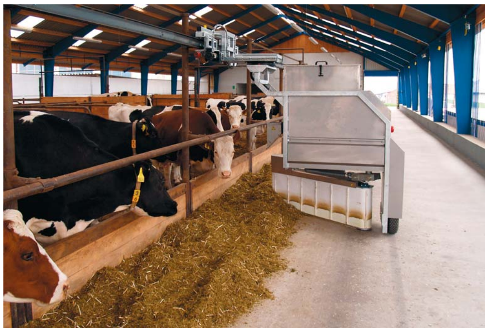
foto 23: Přihrnovací automat je malým zázrakem v produkčních stájích dojnic. Jeho ekonomická návratnost je obdivuhodně krátká, vzhledem k vysokým přínosům.
