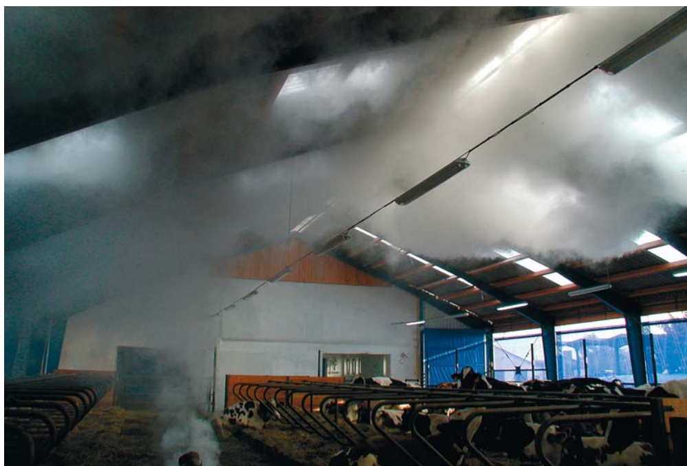
foto 17: Ideálním způsobem zjištění účinnosti přirozené ventilace je kouřová zkouška. Ta chovatele většinou přesvědčí lépe než stovky měření.
